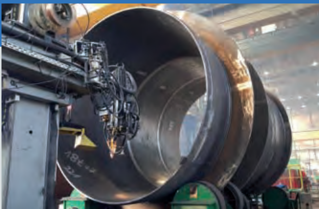
Rohrfertigung - Fabrication of Cans
