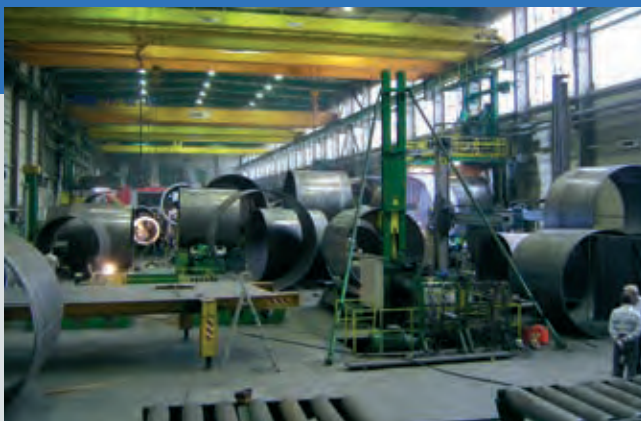
Fertigung Rohrschuss – Manufacturing of Cans
