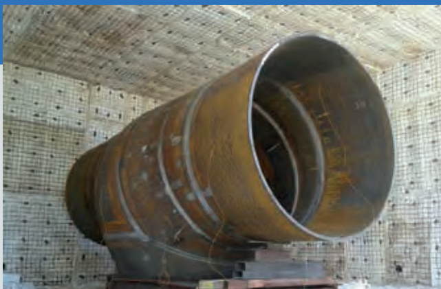
Spannungsarm glühen – Heat Treatment
