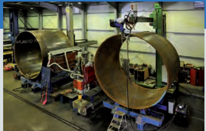
Rohrfertigung – Fabrication of Cans
